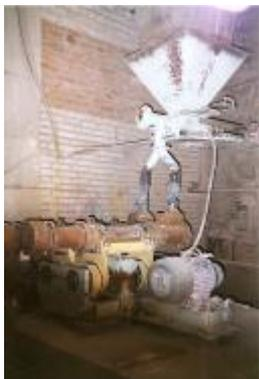
Процесс механоактивации и взаимодействия компонентов рабочей смеси происходят в доли секунды, сразу же после попадания рабочей смеси в вихревой поток. Особенно наглядно это видно при получении цветной извести. Цвет рабочей смеси во входном патрубке барабана – один, а за перегородкой – уже другой. Меняется строение кристалла - изменяется его цвет.
