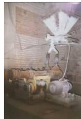
Рис. 2.1 Вибро-центробежная (планетарная) мельница непрерывного действия
